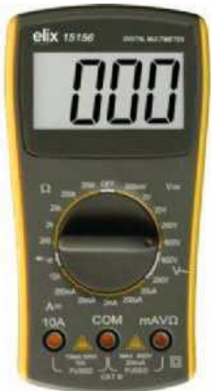
Multímetro digital multifunción Se suministra con cables de medición. - Pantalla LCD de 1999 puntos - 3 ½ dígitos y 26 x 53 mm - Altura de caracteres: 22 mm - Velocidad de actualización: +/- 3 por segundo - Indicación de polaridad negativa - Desbordamiento de la pantalla - Alimentación: Pila de 9 V (incluida) - Prueba de continuidad: Por zumbador interno < 70 - Prueba de diodos - Fusibles: F200 mA/600 V • Longitud (mm) : 126 • Ancho (mm) : 70 • Profundidad (mm) : 24 A0007498
